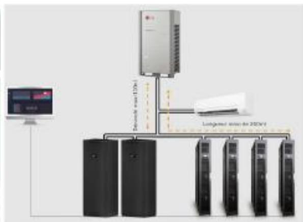
Pour le local existant un système à détente direct avec une unité intérieure gainable sera mis en place pour un encombrement réduit.
