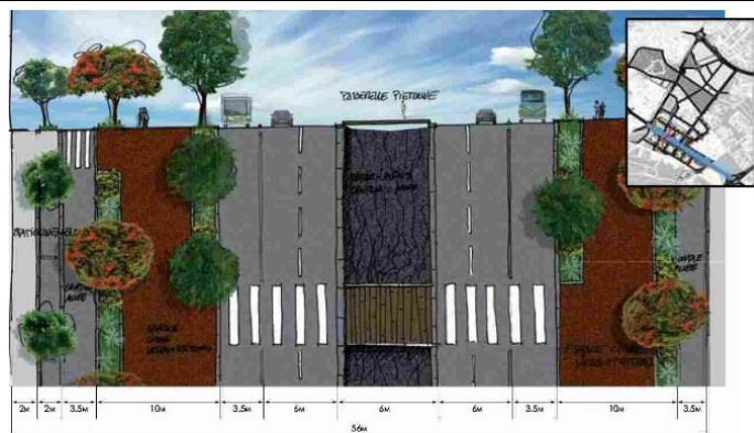
Figure 46 : Profil en travers proposé pour la RN7 (partie Ouest de notre périmètre)
