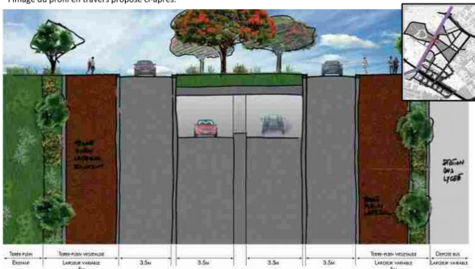
Figure 45 : Profil en travers proposé pour la RN4a au droit du Parc Boisé existant
