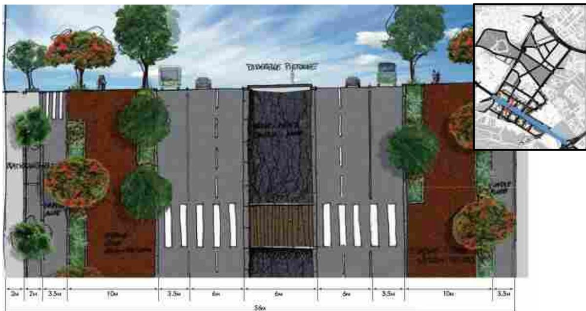
Figure 3 : Profil en travers proposé pour la RN7 (partie Ouest de notre périmètre)
