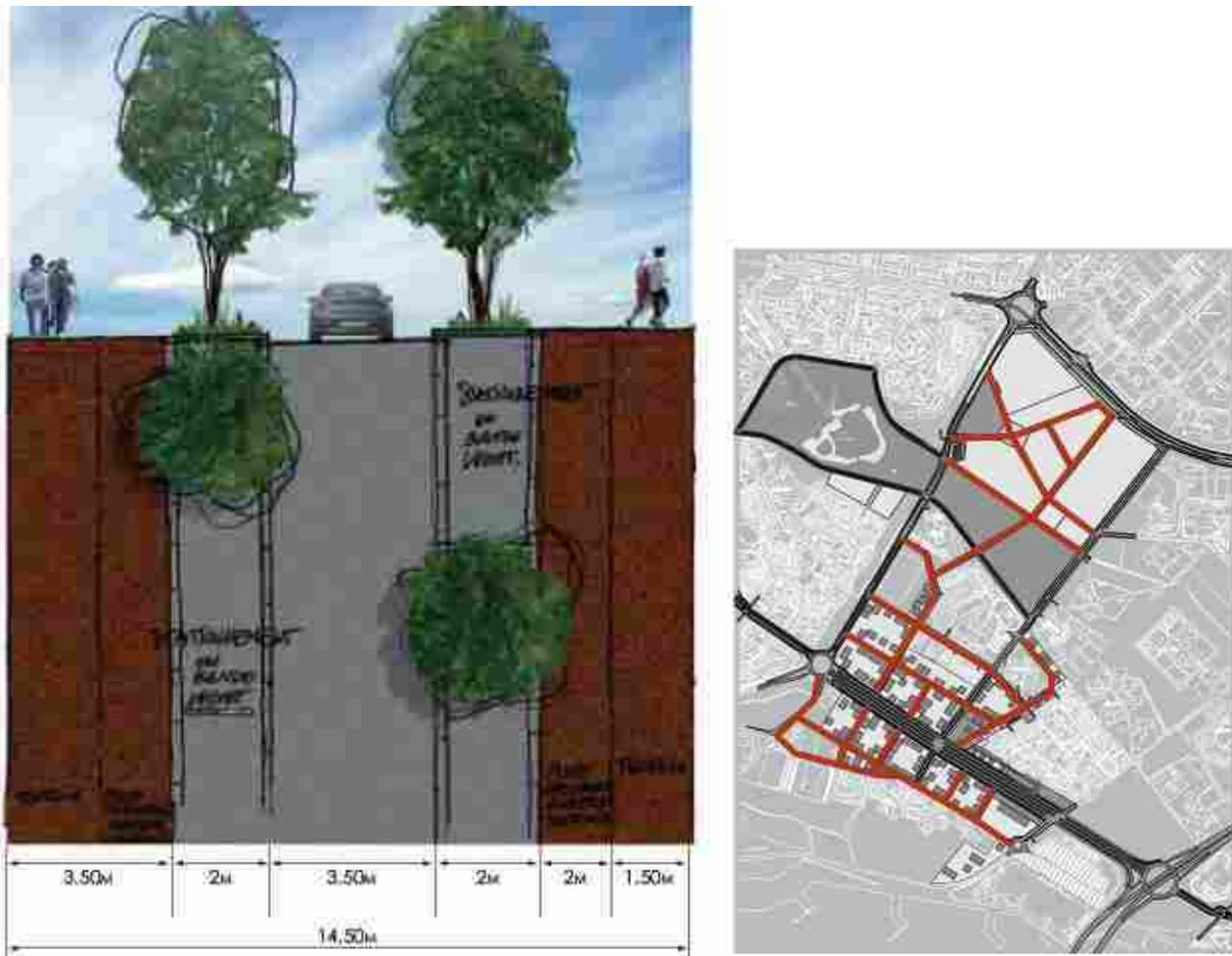
**Figure 48 : Profil en travers proposé au droit des futures voies internes du périmètre**
